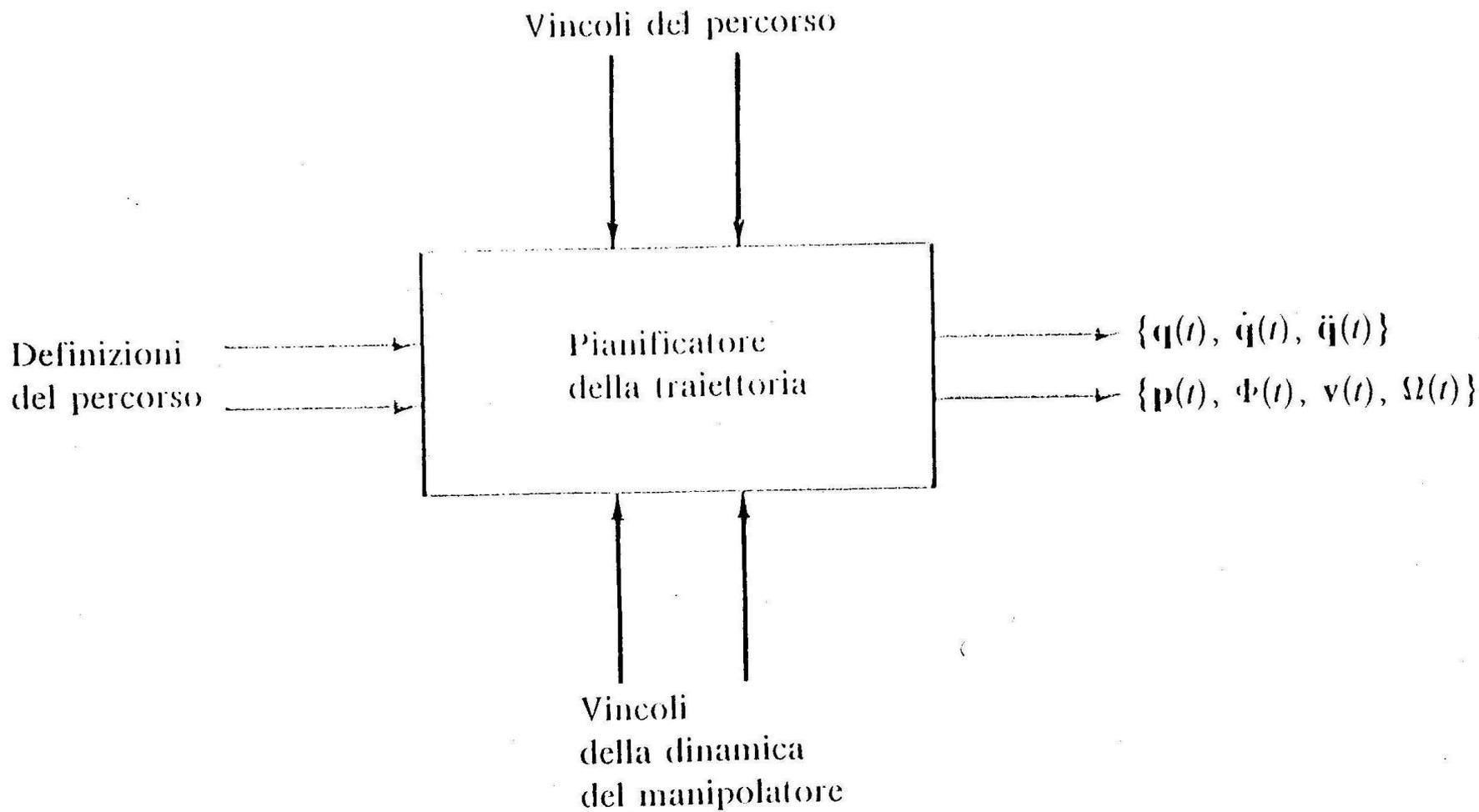
**Figura 4.1** Diagramma a blocchi del pianificatore della traiettoria.
