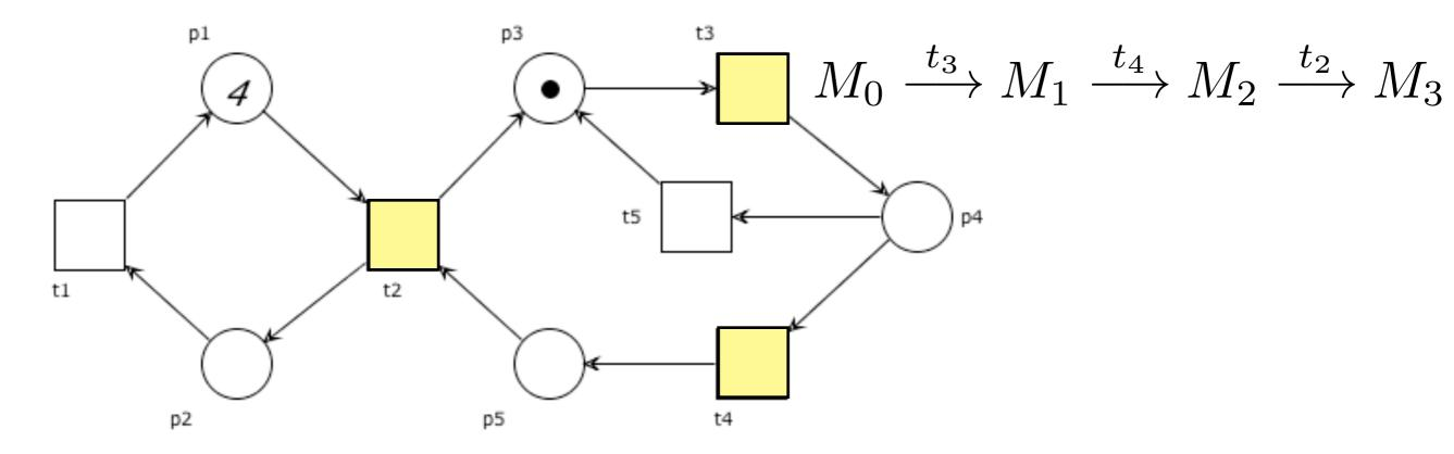
$$\begin{bmatrix} A \\ 0 \\ 0 \\ 0 \\ 1 \end{bmatrix} + \begin{bmatrix} t_2 \\ -1 \\ 1 \\ 1 \\ 0 \\ -1 \end{bmatrix} = \begin{bmatrix} M_3 \\ 1 \\ 1 \\ 1 \\ 0 \\ 0 \end{bmatrix}$$
