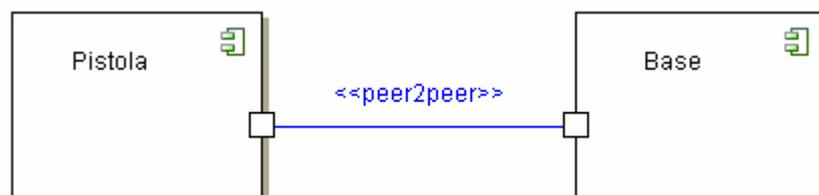
Il seguente diagramma di struttura composita mostra il progetto del componente *Pistola*, mettendo in evidenza le relazioni tra la parte di logica e i driver delle apparecchiature che esso controlla: il lettore digitale della scheda, il lettore ottico di codice a barre e la connessione verso il componente *Base*.
