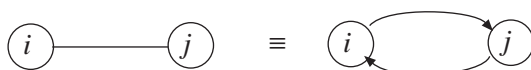
Figura B.1: Equivalenza tra un arco non orientato ed una coppia di archi orientati
