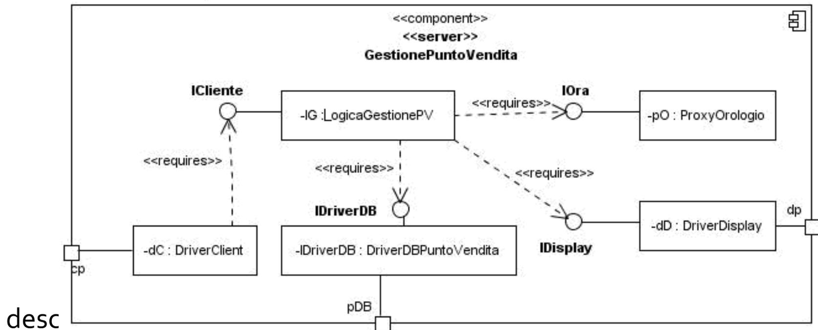
verifica (stub e driver) di LogicaGestionePV. Si assumo di avere già testato il database, e quindi poterlo utilizzare per il test.
