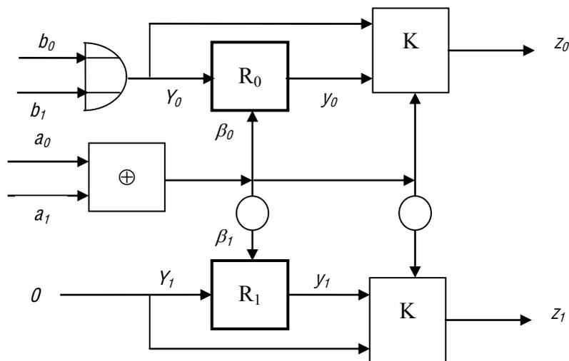
Formalmente, il confrontatore dovrebbe comparire due volte, una per la funzione delle uscite ed una per quella di transizione dello stato interno. Ovviamente, rilevando che due parti di una rete sono identiche, è sempre consentito metterne una sola a comune.
