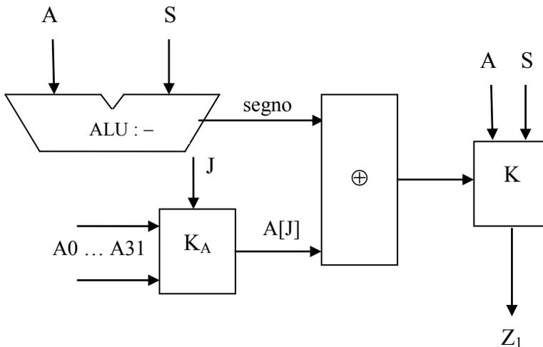
Assumiamo il ritardo di stabilizzazione di una ALU uguale a  $5t_p$ . Usando porte logiche con al massimo 4 ingressi, il commutatore  $K_A$  ha ritardo di stabilizzazione anch'esso uguale a  $5t_p$  (parte AND a 2 livelli di logica e parte OR a 3 livelli di logica). Il ritardo di stabilizzazione di questa rete vale quindi:
