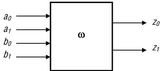
implementa una trasformazione ( $\omega$ ) da stati d'ingresso (combinazioni di  $a_0, a_1, b_0, b_1$ ) a stati di uscita (combinazioni di  $Z_0, Z_1$ ), tale che ad ogni stato d'ingresso corrisponde uno ed un solo stato di uscita. Le specifiche di tale funzione possono essere espresse in un formalismo algoritmico:
